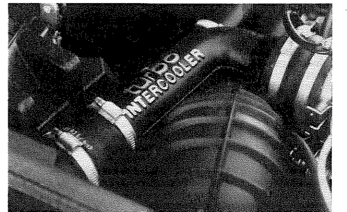
Forbindelsesrør med indstøbt stærkende for 3. generations turbo motorer: Intercooler.
